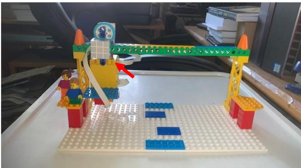
El sensor de luz se tiene que iluminar una luz de la parte derecha o izquierda según el sentido del teleférico.
